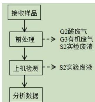
图 5 化学试验流程及产污环节图
